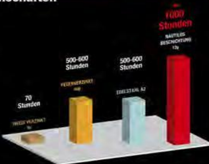
Korrosionsbeständigkeit in Salzspray: Erscheinung von rotem Rost.
