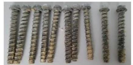
Getestet für 1440 Stunden gemäß ASTM-B117 in Wasser. Links: Atlantis; rechts: HDG 45µm
