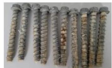
1440-Stunden-Test gemäß ASTM-G85. Links: Atlantis; rechts: HDG 45µm
